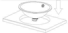
**5.** Klebefläche entstauben und entfetten. Becken in Trägerplatte einsetzen. Frische Klebstoffreste können mit Alkohol entfernt werden.
