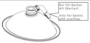
2. Ventil und ggf. Überlauf montieren. Bei Modell EB.R800 optional Überlaufgarnitur ÜG.1 bis zu einer Plattenstärke von 30 mm verwendbar.
