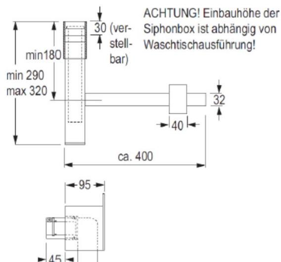
Die Maßtoleranzen (+/-3 mm) und Ebenheitstoleranzen (DIN 18202) unterliegen den üblichen materialspezifischen Toleranzen von Bau- und Werkstoffen, anlehnend an die DIN 18202. Lochbohrungen müssen nach Auflegen des Waschtisches auf die Trägerplatte angezeichnet werden.
