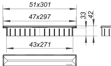
zum Einbau mit Ablaufgehäusen CeraFlex, CeraFlex Plan, CeraFlex senkrecht, DallFlex, DallFlex Plan, DallFlex senkrecht und Duschelementen DallFlex Compact, DallFlex Compact Plan.
