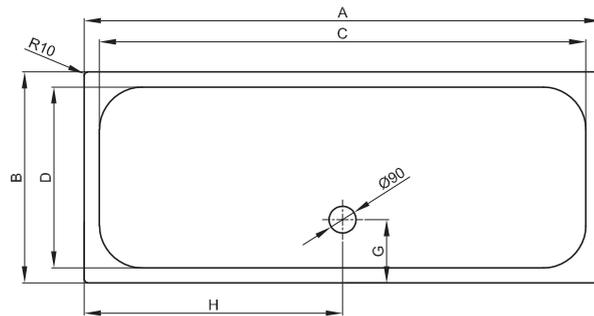
Die Duschwannen ab einer Schenkellänge 1600 mm werden mit einem Mittelablauf auf der langen Seite geliefert.
