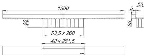
zum Einbau mit Ablaufgehäusen CeraFlex, CeraFlex Plan, CeraFlex senkrecht, DallFlex, DallFlex Plan, DallFlex senkrecht und Duschelementen DallFlex Wall, DallFlex Wall Plan.
