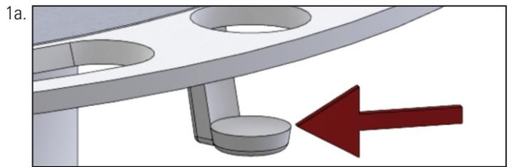
DE Anker entfernbar (z.B. zum Einbau in Holzbalkendecken)
