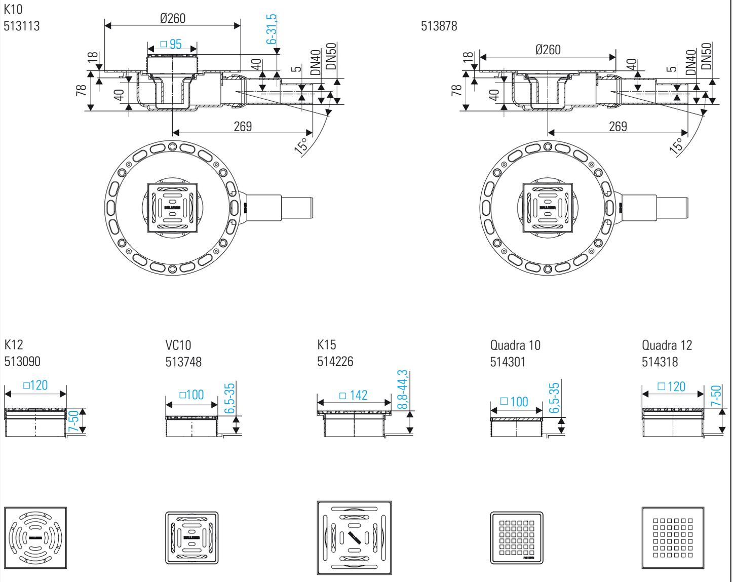
Ablaufleistung nach DIN EN 1253 Tab. 3, (20 mm Anstauhöhe), in Verbindung mit DIN EN 274
