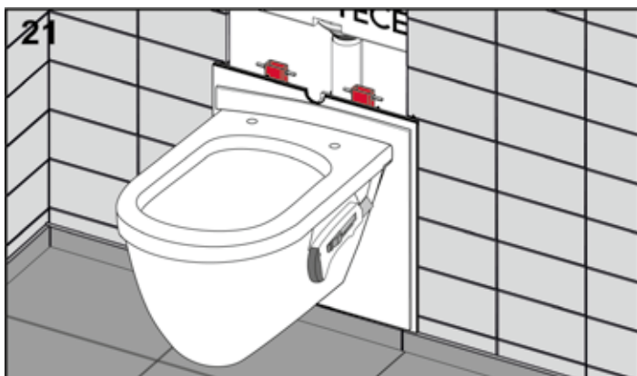
Überstehendes Material des Schallschutzsets abschneiden.
