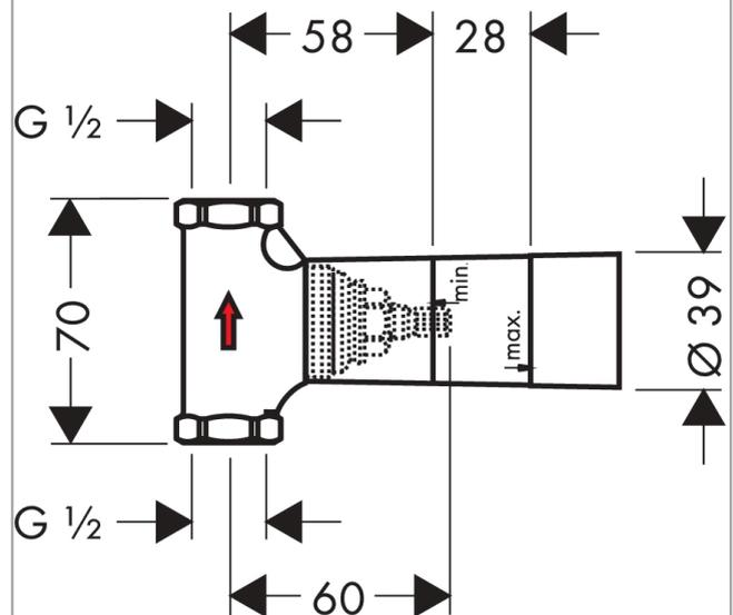
**Grundkörper 40 l/min Unterputz für Absperrventil Keramik DN15**
