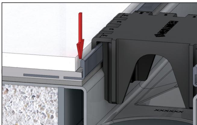
DE Fuge mit zementärem oder elastischem Fugenfüller schließen
