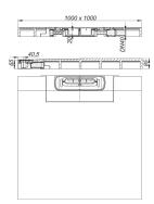
mit wandseitiger Ablaufstelle zum Einbau mit Duschrinnen CeraWall und CeraFloor. Ablaufstutzen DN 40 seitlich, werkzeuglos an drei Seiten variabel montierbar, mit Kugelgelenk verstellbar von  $0-15\,\mathrm{Grad}$
