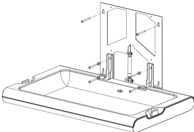
Comprove se os seis parafusos de fixação da unidade à parede foram apertados corretamente e se o trocador de fraldas está fixado à parede de maneira firme.
