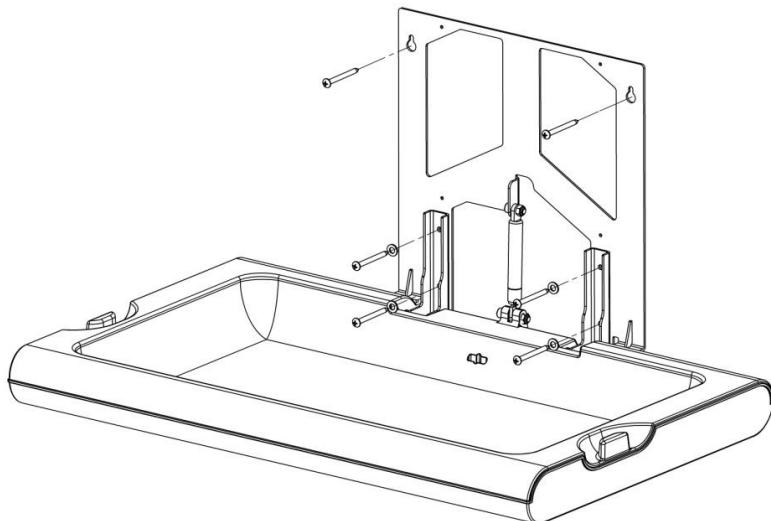
Verificare che le sei viti di fissaggio a parete dell'unità siano state avviate in modo corretto e che il fasciatoio sia assicurato saldamente al muro.
