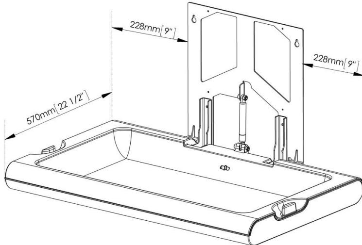
Für die Montage empfehlen wir einen Abstand von 800 mm zwischen Boden und niedrigstem Teil des Wickeltisches. Die nachfolgenden Skizzen zeigen auf welcher Höhe die Löcher gebohrt werden müssen, um den Wickeltisch auf der empfohlenen Höhe anzubringen:
