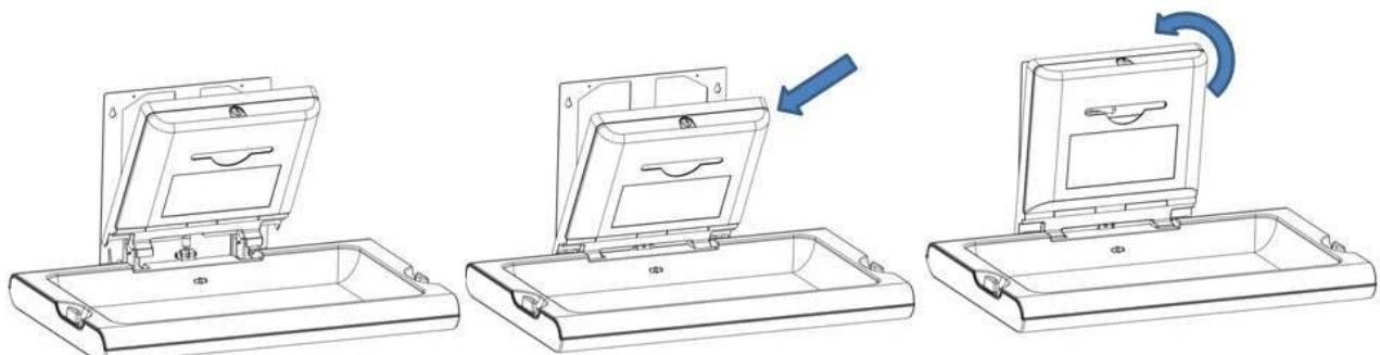
Abrir el dispensador de sábanas con la llave especial suministrada. Los cuatro orificios de fijación de este dispensador de sábanas a la estructura de sujeción del cambi pañales quedarán a la vista.
